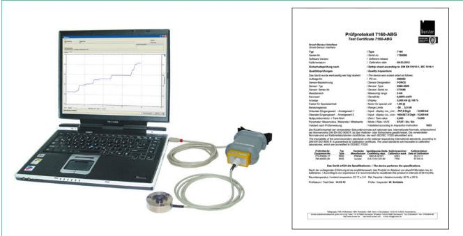
Das Smart-Sensor Interface Typ 7160 wird über die USB-Schnittstelle des angeschlossenen PC versorgt. Daraus wird die Speisespannung für den Kraftsensor in Höhe von ca. 4,5 V generiert. Über den Plug & Measure-Anschluss werden die Daten des angeschlossenen Kraftsensors erkannt. Fortlaufende Messwerte können mit der Konfigurations- und Datenerfassungs-Software DigiCal automatisch erfasst werden, und ohne großen Aufwand kann ein Prüfling auf Einhaltung seiner technischen Daten bewertet werden.
